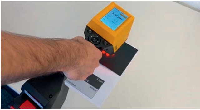
Bild 1 > Schichtdickenmessung mit dem auf der ATO-Technologie basierenden Handmessgerät.
