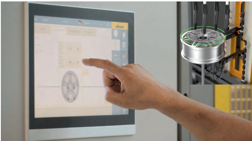
Bild 5 > Per Touchscreen erfolgt die Konfiguration und Steuerung des speziell für die Räderbeschichtung entwickelten Pulverbeschichtungssystems.
