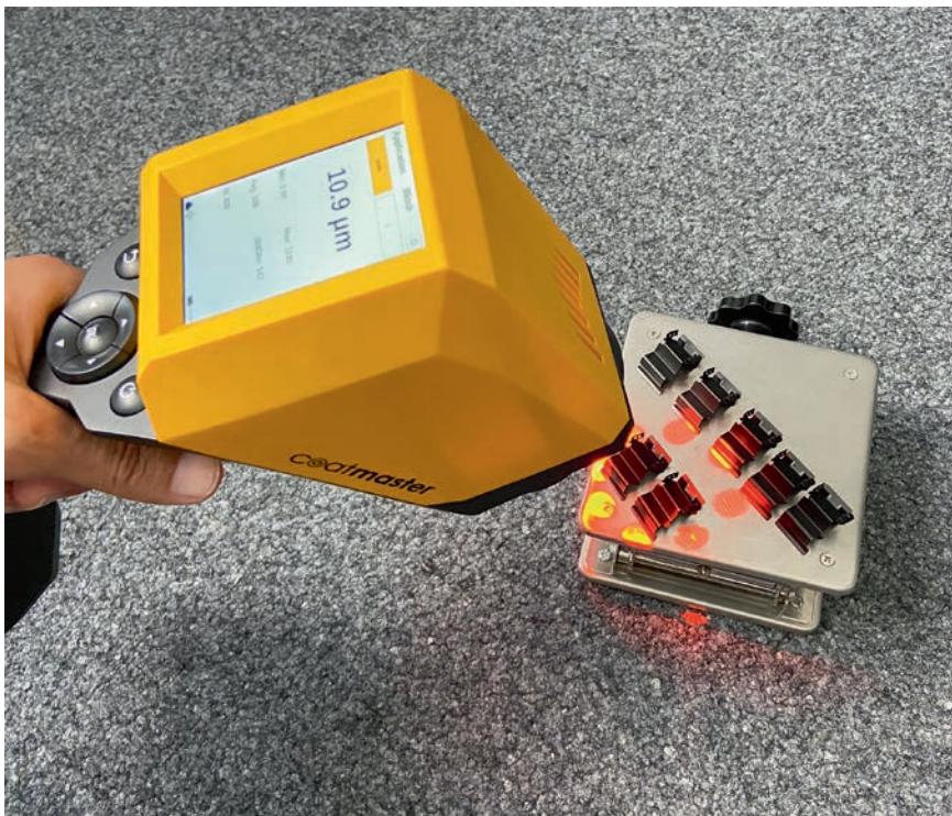
Mobiles Messgerät zur berührungslosen Schichtdickenmessung.
